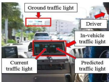
バス路線の中にある交通信号機の位置とサイクルをあらかじめ、自車の中に保存しておけば、GPS信号の位置と時刻情報から、進入する交差点の信号灯火を知ることができる。交差点進入時に、GPS信号から、自車から交差点までの距離と、自車の速度を取得する。それらを用いて、自車が交差点に到着する時刻を算出し、算出した到着時刻と信号サイクル情報を用いて、通過する時の信号灯火を予測する。交差点手前での黄色現示（ジレンマゾーン）を回避するため、信号灯火の予測では黄信号は赤信号として認識する。予測信号が青信号の時は、自車は現在の速度を維持し、予測信号が赤信号の時は、交差点の停止線で停止できるように、定められたランカーブに沿って減速する。予測信号を用いることにより、急減速を避けることができる。
